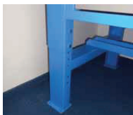
Одно из основных преимуществ новой модели верстака - регулировка опор по высоте.
